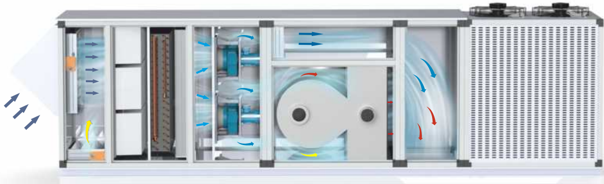
Схема распределения воздуха в крышном агрегате климатическом
